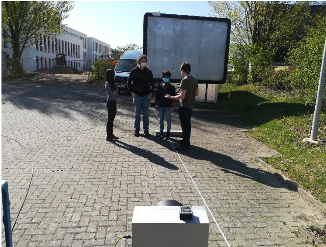
Abb. 1 Die radarbasierte Erfassung der Vitalparameter mehrerer Personen wird in einer Szene mit natürlicher Bewegung am Fraunhofer FHR getestet (von links nach rechts: Siying Wang, Alexander Bauer, Manjunath Thindlu Rudrappa, Reinhold Herschel).
